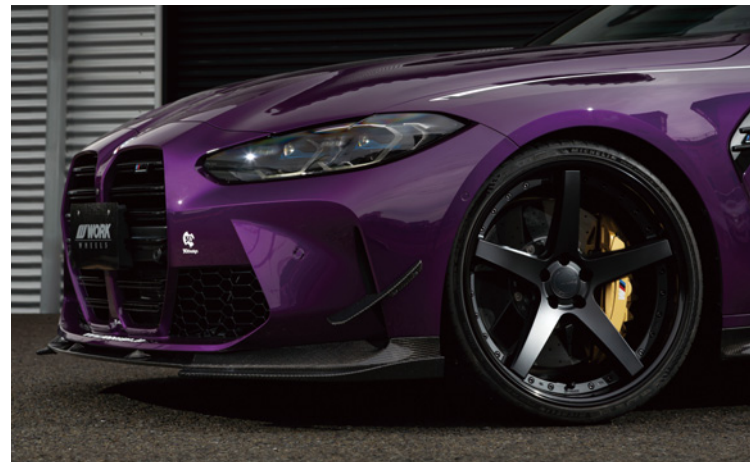
【GNOSIS CVF】 リムアレンジ：ブラックアルマイト (オプション：センターキャップ、ブラッククロームピասポルト、ブラックエアバルブ)、特殊P.C.D.
