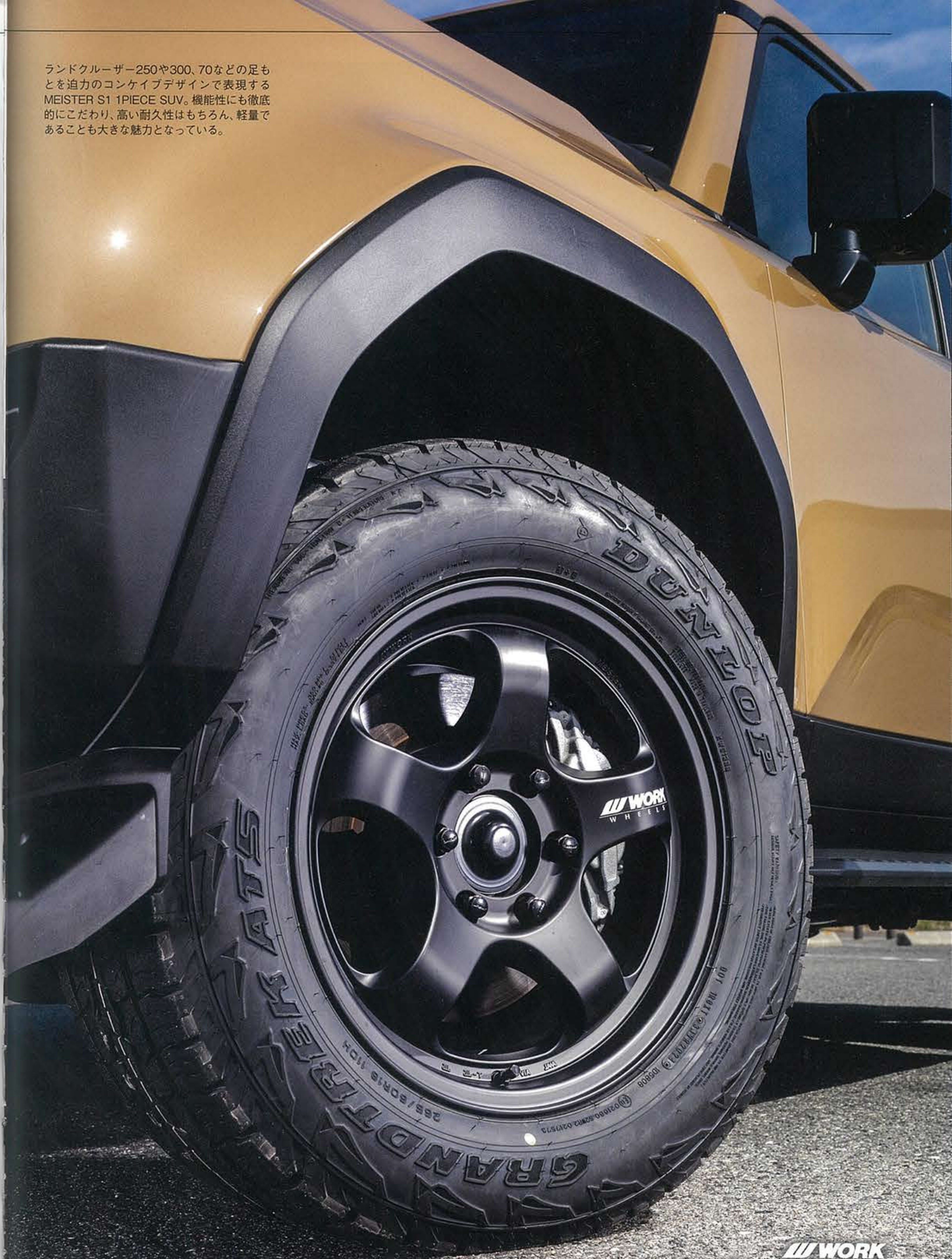
大きく張り出したスポークは美しいコンケイブデザインを表現。リムフランジにはオフロード走行に耐えうるリップ構造を採用する。センターフェイスはインセットごとに変更。極限まで無駄を省くなど徹底した作り込みがなされている。
