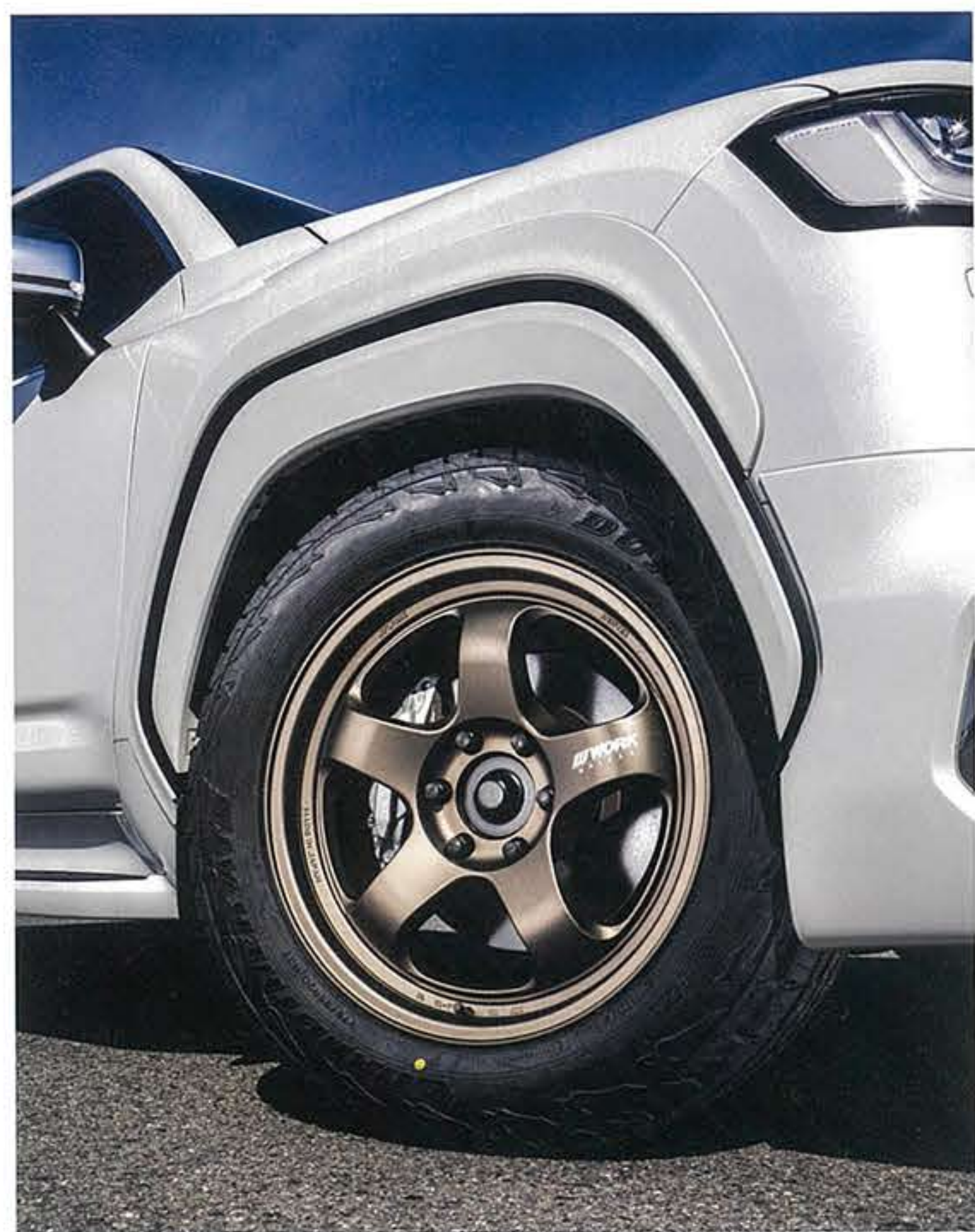
大きく張り出したスポークは美しいコンケイブデザインを表現。リムフランジにはオフロード走行に耐えうるリップ構造を採用する。センターフェイスはインセットごとに変更。極限まで無駄を省くなど徹底した作り込みがなされている。
