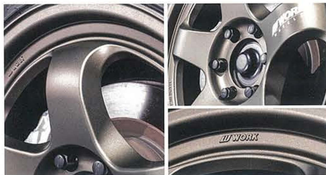
大きく張り出したスポークは美しいコンケイブデザインを表現。リムフランジにはオフロード走行に耐えうるリップ構造を採用する。センターフェイスはインセットごとに変更。極限まで無駄を省くなど徹底した作り込みがなされている。
