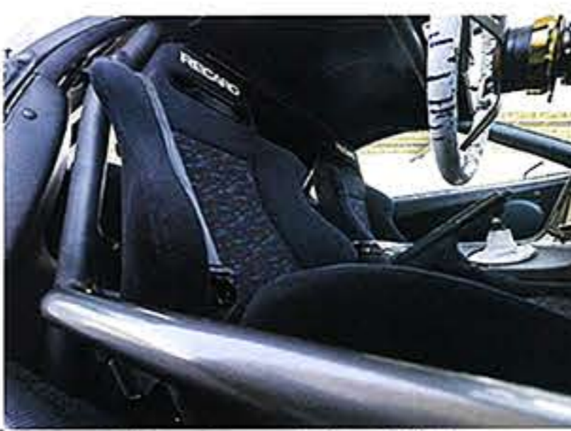
ダッシュ貫通タイプのロールケージはサイドバーを含む8点式だが、クロスバーも所有していて追加が予定されている。ラグジュのサブウーファー、パワーアンプ、エアサスタックを収納するBOXは自作だ。
