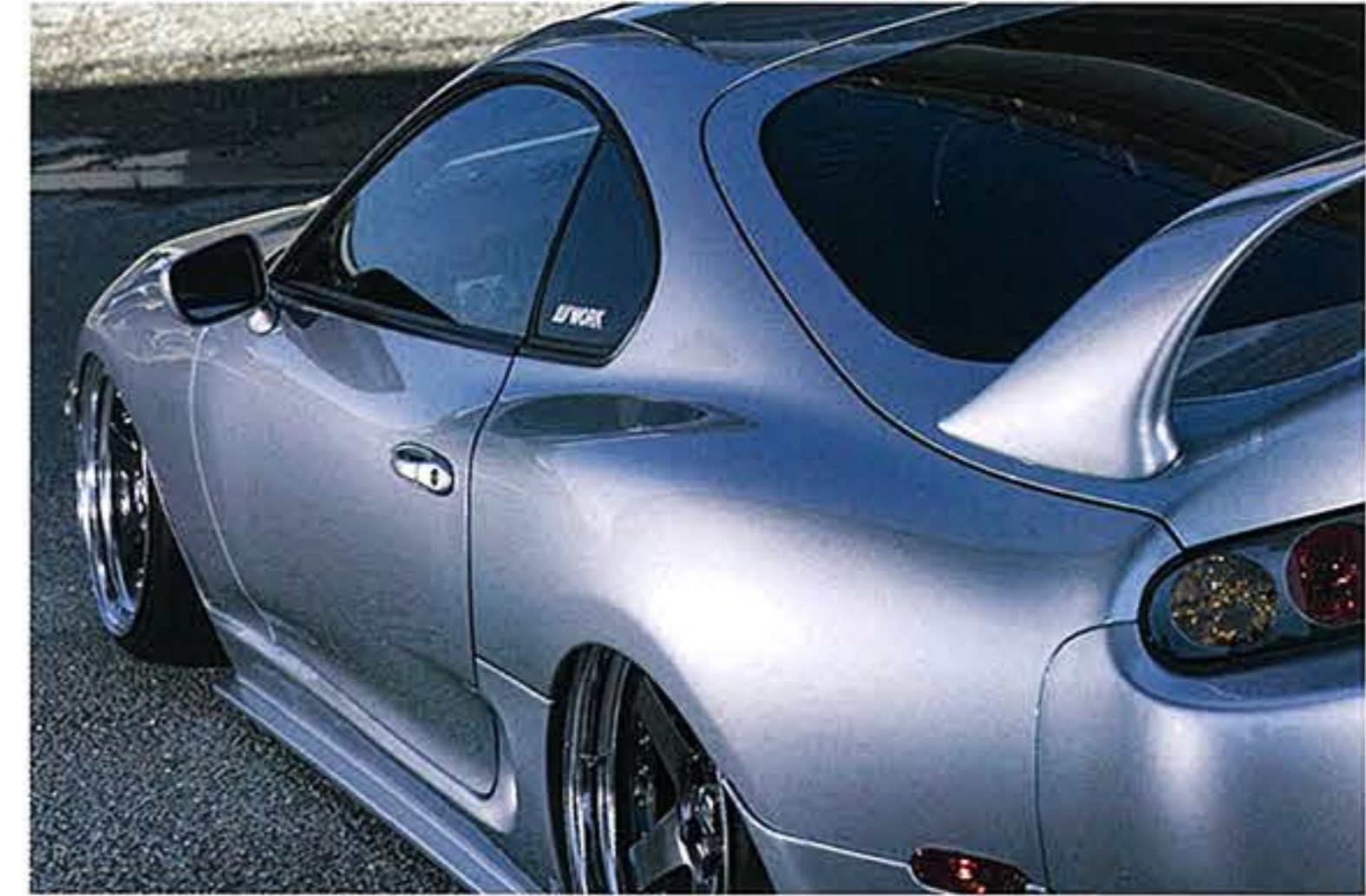
前後フェンダーはツメ折りのほか、片側10mmほど叩き出している。さらに、調整式サスペンションアームを駆使したキャンバー設定でタイヤとの干渉を回避して、エアサスでのローフォルム創出を実現する。
