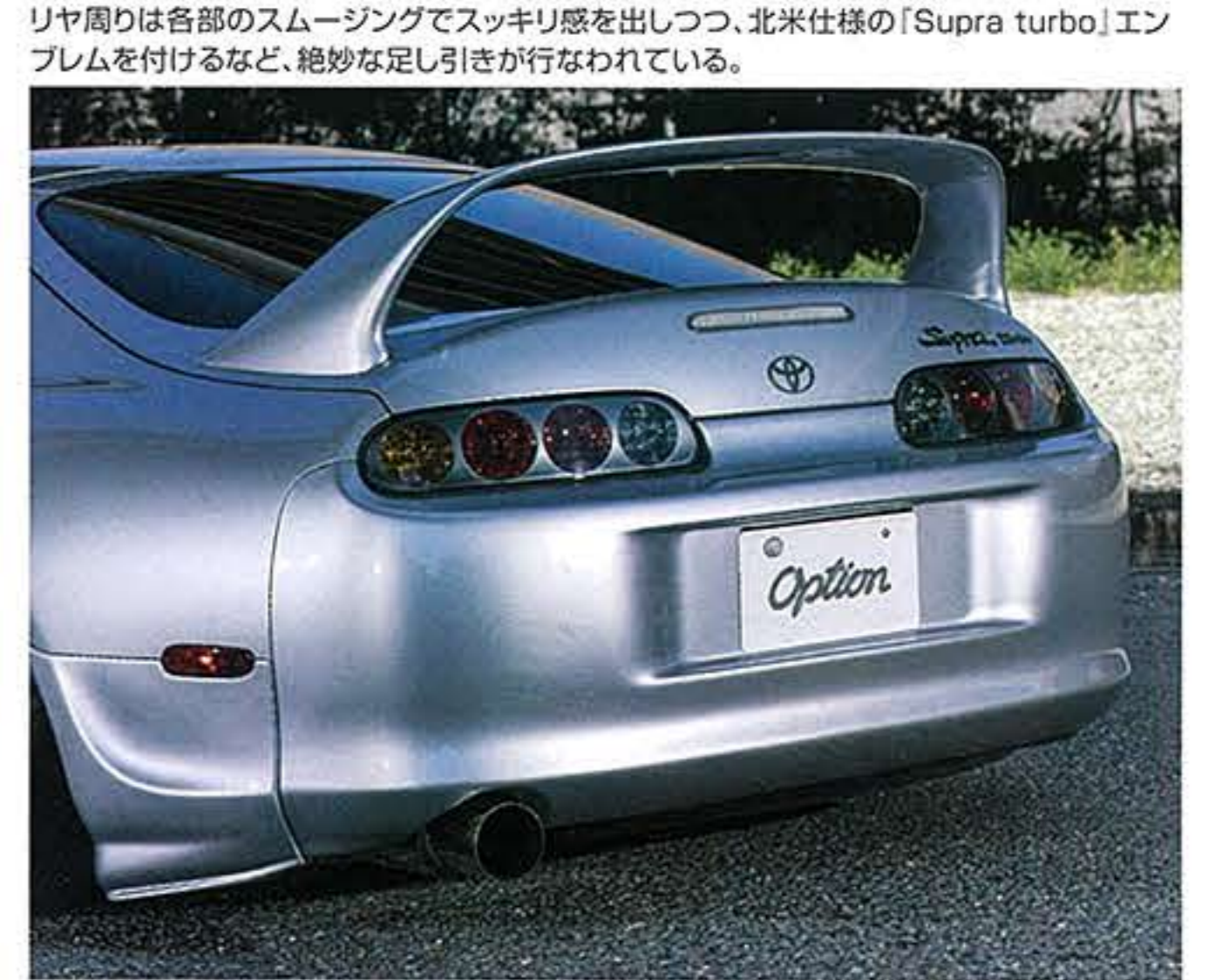
前後フェンダーはツメ折りのほか、片側10mmほど叩き出している。さらに、調整式サスペンションアームを駆使したキャンバー設定でタイヤとの干渉を回避して、エアサスでのローフォルム創出を実現する。
