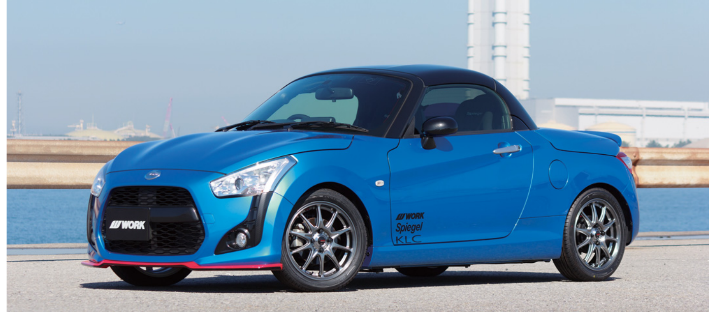
[SIZE] FRONT : 15inch × 5.0J INSET 45mm TIRE : 165/55-15 REAR : 15inch × 5.0J INSET 45mm TIRE : 165/55-15 COLOR : ハイパーシルバーマシニング (HSM)
