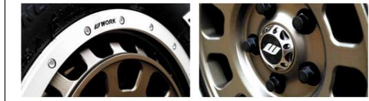
歯車型のディスクデザインは基となる本格オフロード競技ホイールを忠実に再現して構成。市販品もオフロードで使える強度・剛性を確保した WORK 製ホイールだ。縁取られたビードロックリング形状のリムフランジなど、ギミックも数多い。
