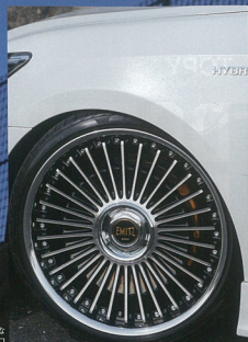
全アルミホークの18インチ専用160スリットホ 配置。組立て式ホイールであることと主軸す るために、車両重量の増大は10%程度である。
