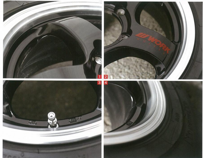
1.極太のスポークはセンターに落ち込むようにリムへとつながっている。丁寧にデザインされたことが分かる有機的な曲線が魅力的だ。2.ステッカーの色は白と赤から選択可能。3.JWLとJWL-Tの双方の規格を取得しているため旧型ジムニーでも車検OKだ。4.リムは切削加工が施され高級感にあふれる。
