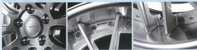
センター部とスポークを拡大、そのリムに黒染、5Hハブと一体成型のスポークの深さを拡大、スポーク端に縮細した部分の拡大、リム、そのリムとディスク間で強度を確保、ディスクとリアブレーキの位置関係。
