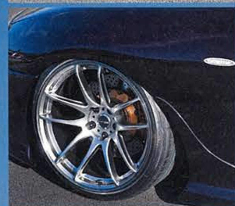
センターハートはコンパクトかつ深くに設計。スポークの長さとともに、コンケイブを強調する。尚、取材車両のJZA80が装着する10.5Jx19は、4種のテーパーサイズの中で最深のウルトラディープだ。
