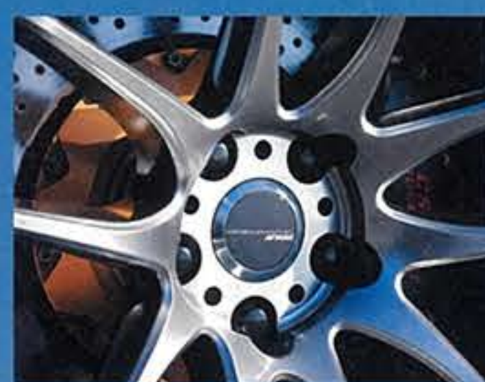
センターハートはコンパクトかつ深くに設計。スポークの長さとともに、コンケイブを強調する。尚、取材車両のJZA80が装着する10.5Jx19は、4種のテーパーサイズの中で最深のウルトラディープだ。
